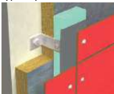
Pose sur ossature bois
